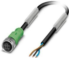
Sensor-/Aktor-Kabel, 3-polig, PUR halogenfrei, schwarzgrau RAL 7021, freies Leitungsende, auf Buchse gerade M12, Kodierung: A, Kabellänge: 3 m
