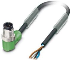
Sensor-/Aktor-Kabel, 4-polig, PUR halogenfrei, schwarzgrau RAL 7021, Stecker gewinkelt M12, Kodierung: A, auf freies Leitungsende, Kabellänge: 10 m
