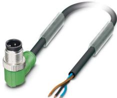
Sensor-/Aktor-Kabel, 3-polig, PUR halogenfrei, schwarzgrau RAL 7021, Stecker gewinkelt M12, Kodierung: A, auf freies Leitungsende, Kabellänge: 10 m
