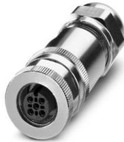
Steckverbinder, Universal, 5-polig, geschirmt, Buchse gerade M12, Kodierung: A, Schraubanschluss, Rändelmaterial: Messing, vernickelt, Kabelverschraubung Pg7, Leitungsaußendurchmesser 4 mm ... 6 mm
