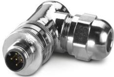
Steckverbinder, Universal, 5-polig, geschirmt, Stecker gewinkelt M12, Kodierung: A, Schraubanschluss, Rändelmaterial: Messing, vernickelt, Kabelverschraubung Pg9, Leitungsaußendurchmesser 6 mm ... 8 mm
