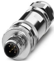
Steckverbinder, Universal, 5-polig, geschirmt, Stecker gerade M12, Kodierung: A, Schraubanschluss, Rändelmaterial: Messing, vernickelt, Kabelverschraubung Pg9, Leitungsaußendurchmesser 6 mm ... 8 mm
