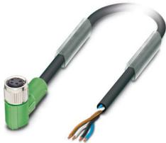
Sensor-/Aktor-Kabel, 4-polig, PUR halogenfrei, schwarzgrau RAL 7021, freies Leitungsende, auf Buchse gewinkelt M8, Kodierung: A, Kabellänge: 10 m
