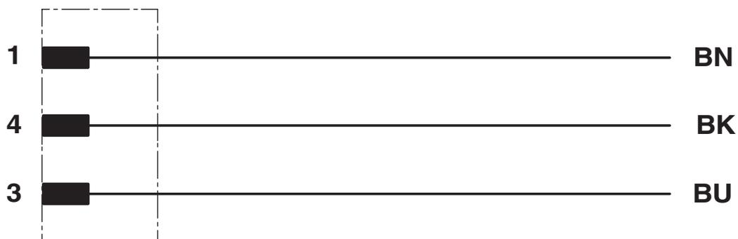
Kontaktbelegung des M8-Steckers
