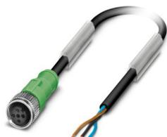
Sensor-/Aktor-Kabel, 3-polig, PUR halogenfrei, schwarzgrau RAL 7021, freies Leitungsende, auf Buchse gerade M12, Kodierung: A, Kabellänge: 20 m
