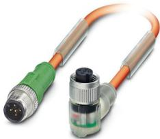
Sensor-/Aktor-Kabel, 5-polig, PUR halogenfrei, strahlenvernetzt, orange RAL 2003, Stecker gerade M12, Kodierung: A, mit 3 LEDs, auf Buchse gewinkelt M12, Kodierung: A, mit 3 LEDs, Kabellänge: 1 m, kundenspezifische Variante
