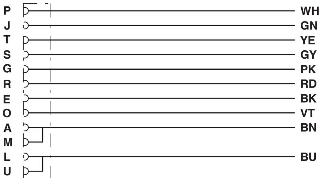
Kontaktbelegung der M16-Buchse
