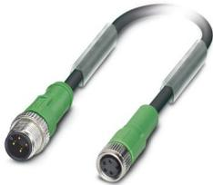
Sensor-/Aktor-Kabel, 4-polig, PUR halogenfrei, schwarzgrau RAL 7021, Stecker gerade M12, Kodierung: A, auf Buchse gerade M8, Kodierung: A, Kabellänge: 1,5 m
