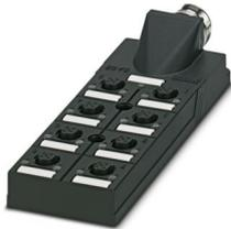
Verteilerbox, Anwendung: Standard, Anschlussart: M12-Buchse Kunststoff, Anzahl der Steckplätze: 8, Polzahl: 5, Kodierung: A, Steckplatzbelegung: doppelt, Statusanzeige: nein, Universal; Stammleitungsanschluss: M23-Steckanschluss 180°, Schirmung: nein
