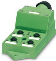
Verteilerbox, Anschlussart: M12-Buchse Kunststoff, Anzahl der Steckplätze: 4, Polzahl: 5, Kodierung: A, Steckplatzbelegung: doppelt, Statusanzeige: ja, PNP; Stammleitungsanschluss: Steckbarer Schraubanschluss 180°, Schirmung: nein
