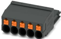
Leiterplattenstecker, Nennquerschnitt: 4 mm<sup>2</sup>, Farbe: schwarz, Nennstrom: 24 A, Bemessungsspannung (III/2): 1000 V, Kontaktoberfläche: Sn, Kontaktart: Buchse, Anzahl der Reihen: 1, Polzahl: 6, Artikelfamilie: SPC 4/..-ST, Rastermaß: 6,35 mm, Anschlussart: Push-in-Federanschluss, Anschlussrichtung Leiter/Platine: 0 °, Rasthaken: - ohne Rasthaken, Stecksystem: COMBICON PC 4, Verriegelung: ohne, Befestigungsart: ohne, Verpackungsart: verpackt im Karton
