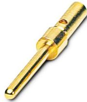
Crimpkontakt, für D-SUB-Kontakteinsätze mit Standard-Kontaktdichte, Stift, Anschlussquerschnitt AWG 24 ... 20, gestanzt, vergoldet
