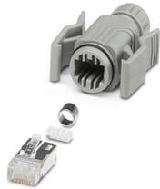
Tüllengehäuse, Bauform: RJ45, Schutzart: IP20, Polzahl: 8, CAT5 (IEC 11801:2002), Material: Kunststoff, Anschlussart: Crimpanschluss, Kabelabgang: gerade, Farbe: grau
