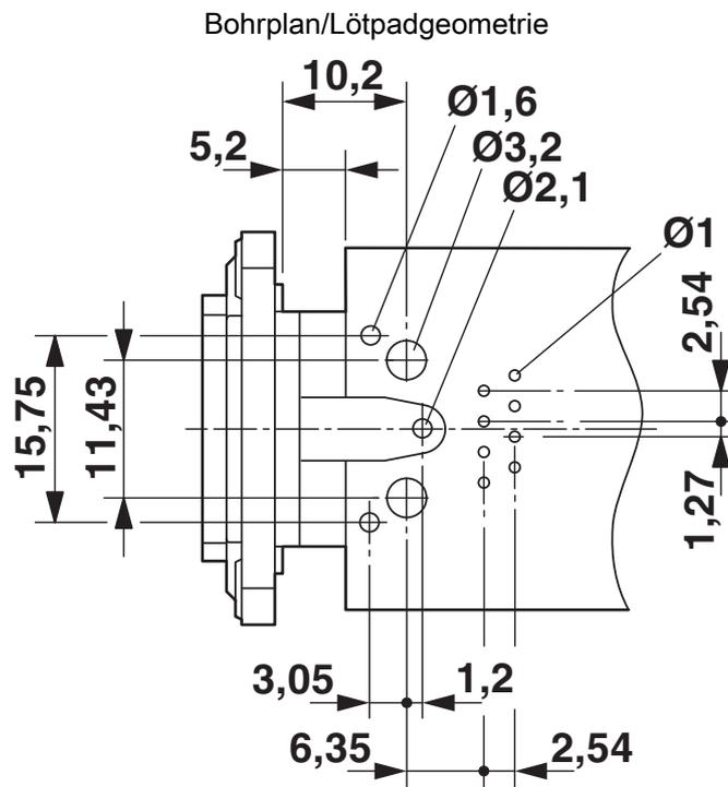
Bohrplan für VS-08-BU-RJ45-6/LH-1
