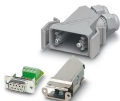
D-SUB-Steckverbinder, Schutzart: IP20, Polzahl: 9, Material: Kunststoff, Anschlussart: Schraubanschluss, Anschlussquerschnitt: AWG 26- 20, Kabelabgang: schräg, mit integriertem Abschlusswiderstand, Gehäusegröße: 1, Farbe: grau, CAN
