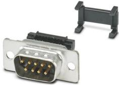
D-SUB-Kontakteinsatz, Shell-Größe 1, mit 9 Signalkontakten, Kontaktart Stift, Flachbandkabelanschluss, abgewinkelt, Befestigung mittels Bohrung 3 mm, für Anbaurahmen VS-09-...
