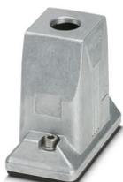
HEAVYCON ADVANCE-Tüllegehäuse, B10, mit Schraubverriegelung (Innensechskant) aus Edelstahl, seewasserbeständiges Aluminium, Höhe 93,7 mm, mit Gewinde 1x M32, geradem Kabelabgang, ohne Oberfläche; leitfähige Dichtung (EMV-Eigenschaften)
