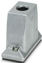
HEAVYCON ADVANCE-Tüllengehäuse, B16, mit Schraubverriegelung (Innensechskant) aus Edelstahl, seewasserbeständiges Aluminium, Höhe 93,7 mm, mit Gewinde, 1x M25, gerader Kabelabgang, ohne Oberfläche, leitfähige Dichtung (EMV-Eigenschaften)
