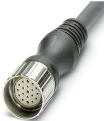
Stammleitung, Anwendung: Sensor-/Aktor-Box, Polzahl: 19, Steckplatzbelegung: doppelt, Statusanzeige: nein; Stammleitungsanschluss: M23-Steckanschluss, PUR/PVC, Leitungslänge: 5 m, Schirmung: nein, dieser Artikel ist voraussichtlich ab 2025-Q4 nach RoHS II ohne Ausnahme 6c (Pb < 0,1 %) bleifrei, auf Anfrage ist eine bleifreie Alternative vorab möglich
