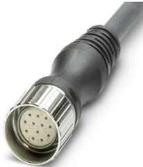
Stammleitung, Anwendung: Sensor-/Aktor-Box, Polzahl: 12, Steckplatzbelegung: einfach, Statusanzeige: nein; Stammleitungsanschluss: M23-Steckanschluss, PUR/PVC, Leitungslänge: 5 m, Schirmung: nein, dieser Artikel ist voraussichtlich ab 2025-Q4 nach RoHS II ohne Ausnahme 6c (Pb < 0,1 %) bleifrei, auf Anfrage ist eine bleifreie Alternative vorab möglich
