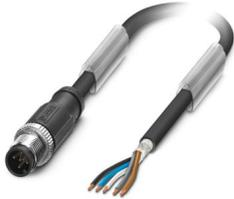
Sensor-/Aktor-Kabel, 5-polig, PUR halogenfrei, schwarzgrau RAL 7021, geschirmt (Advanced Shielding Technology), Stecker gerade M12, Kodierung: A, auf freies Leitungsende, Kabellänge: 3 m
