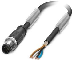
Sensor-/Aktor-Kabel, 4-polig, PUR halogenfrei, schwarzgrau RAL 7021, geschirmt (Advanced Shielding Technology), Stecker gerade M12, Kodierung: A, auf freies Leitungsende, Kabellänge: 1,5 m
