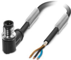
Sensor-/Aktor-Kabel, 3-polig, PUR halogenfrei, schwarzgrau RAL 7021, geschirmt (Advanced Shielding Technology), Stecker gewinkelt M12, Kodierung: A, auf freies Leitungsende, Kabellänge: 1,5 m
