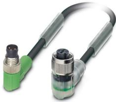
Sensor-/Aktor-Kabel, 3-polig, PUR halogenfrei, schwarzgrau RAL 7021, Stecker gewinkelt M8, Kodierung: A, mit 2 LEDs, auf Buchse gewinkelt M12, Kodierung: A, mit 2 LEDs, Kabellänge: 3 m
