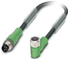
Sensor-/Aktor-Kabel, 4-polig, PUR halogenfrei, schwarzgrau RAL 7021, Stecker gerade M8, Kodierung: A, auf Buchse gewinkelt M8, Kodierung: A, Kabellänge: 0,6 m
