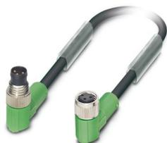
Sensor-/Aktor-Kabel, 3-polig, PUR halogenfrei, schwarzgrau RAL 7021, Stecker gewinkelt M8, Kodierung: A, auf Buchse gewinkelt M8, Kodierung: A, Kabellänge: 3 m
