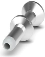
Crimpkontakt, Serie: HC-M-...-25, Stift, gedreht, Kontaktdurchmesser: 6 mm, Anschlussquerschnitt: 6 mm<sup>2</sup> ... 6 mm<sup>2</sup>, AWG 10...10, Material Kontakt: Cu-Legierung
