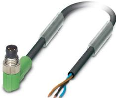
Sensor-/Aktor-Kabel, 3-polig, PUR halogenfrei, schwarzgrau RAL 7021, Stecker gewinkelt M8, Kodierung: A, auf freies Leitungsende, Kabellänge: 3 m
