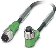
Sensor-/Aktor-Kabel, 5-polig, PUR halogenfrei, schwarzgrau RAL 7021, Stecker gerade M12, Kodierung: A, auf Buchse gewinkelt M12, Kodierung: A, Kabellänge: 0,3 m
