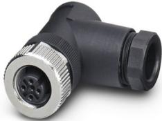
Steckverbinder, Universal, 5-polig, Buchse gewinkelt M12, Kodierung: A, Schraubanschluss, Rändelmaterial: Zinkdruckguss, vernickelt, Kabelverschraubung Pg9, Leitungsaußendurchmesser 6 mm ... 8 mm
