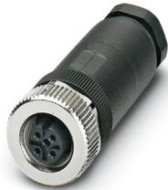
Steckverbinder, Universal, 5-polig, Buchse gerade M12, Kodierung: A, Schraubanschluss, Rändelmaterial: Zinkdruckguss, vernickelt, Kabelverschraubung Pg9, Leitungsaußendurchmesser 6 mm ... 8 mm
