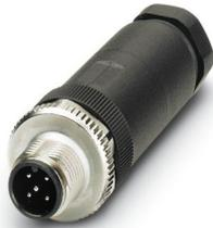
Steckverbinder, Universal, 5-polig, Stecker gerade M12, Kodierung: A, Schraubanschluss, Rändelmaterial: Zinkdruckguss, vernickelt, Kabelverschraubung Pg9, Leitungsaußendurchmesser 6 mm ... 8 mm
