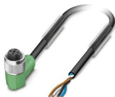
Sensor-/Aktor-Kabel, 4-polig, PUR halogenfrei, schwarzgrau RAL 7021, freies Leitungsende, auf Buchse gewinkelt M12, Kodierung: A, Kabellänge: 10 m
