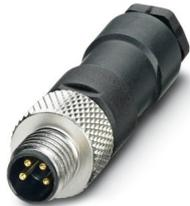
Steckverbinder, Universal, 4-polig, Stecker gerade M8, Kodierung: A, Lötanschluss, Rändelmaterial: Messing, vernickelt, Leitungsaußendurchmesser 3,5 mm ... 5 mm
