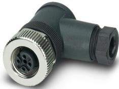
Steckverbinder, Universal, 4-polig, Buchse gewinkelt M12, Kodierung: A, Schraubanschluss, Rändelmaterial: Zinkdruckguss, vernickelt, Kabelverschraubung Pg7, Leitungsaußendurchmesser 4 mm ... 6 mm
