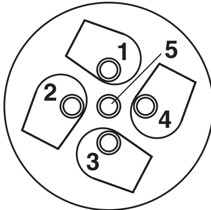
Kabelanschlusseite M12 (Schraubanschluss)
