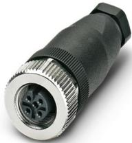
Steckverbinder, Universal, 4-polig, Buchse gerade M12, Kodierung: A, Schraubanschluss, Rändelmaterial: Zinkdruckguss, vernickelt, Kabelverschraubung Pg7, Leitungsaußendurchmesser 4 mm ... 6 mm
