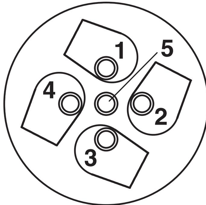
Kabelanschlusseite M12 (Schraubanschluss)
