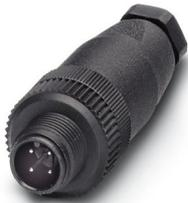
Steckverbinder, Universal, 4-polig, Stecker gerade M12, Kodierung: A, Schraubanschluss, Rändelmaterial: Kunststoff, Kabelverschraubung Pg7, Leitungsaußendurchmesser 4 mm ... 6 mm
