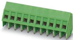
Leiterplattenklemme, Nennstrom: 17,5 A, Bemessungsspannung (III/2): 400 V, Nennquerschnitt: 1,5 mm<sup>2</sup>, Anzahl der Reihen: 1, Polzahl pro Reihe: 14, Artikelfamilie: SMKDSP 1,5, Rastermaß: 5 mm, Anschlussart: Schraubanschluss mit Zughülse, Schraubenangriffsform: L Längsschlitz, Montage: Wellenlöten, Anschlussrichtung Leiter/Platine: 55 °, Farbe: grün, Pin-Layout: Lineares Pinning, Pinlänge [P]: 3,5 mm, Anzahl der Lötpins pro Potenzial: 1, Verpackungsart: verpackt im Karton
