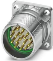
M23, Gerätesteckverbinder Vorderwand, Serie: M23 PRO, gerade, geschirmt: ja, für Standard- und ONECLICK-Schnellverriegelung, Polzahl: 16, Drehsinn: Standard, Kontaktart: Stift, Lötanschluss, Flanschmaß: 28 mm x 28 mm, Kodierung: N, Artikel ist bleifrei nach RoHS II ohne Ausnahme 6c (Pb < 0,1 %)
