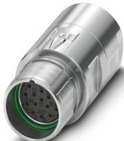
M23, Kupplungssteckverbinder, Serie: M23 PRO, gerade, geschirmt: ja, für Standard- und ONECLICK-Schnellverriegelung, Polzahl: 16, Drehsinn: Standard, Kontaktart: Buchse, Lötanschluss, Kabeldurchmesserbereich: 9 mm ... 15 mm, Kodierung: N, Artikel ist bleifrei nach RoHS II ohne Ausnahme 6c (Pb < 0,1 %)
