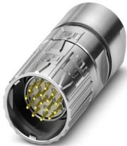
M23, Kabelsteckverbinder, Serie: M23 PRO, gerade, geschirmt: ja, ONECLICK-Schnellverriegelung, Polzahl: 16, Drehsinn: Standard, Kontaktart: Stift, Lötanschluss, Kabeldurchmesserbereich: 4 mm ... 8,5 mm, Kodierung: N, Artikel ist bleifrei nach RoHS II ohne Ausnahme 6c (Pb < 0,1 %)
