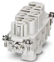
Kontakteinsatz, Polzahl: 4+PE, Baugröße: B16, Leistungskontakte: 4, Steuerkontakte: 0, Buchse, Schraubanschluss, 830 V, 80 A, 1,5 mm<sup>2</sup> ... 16 mm<sup>2</sup>, Anwendung: Leistung
