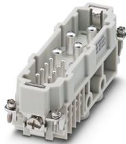
Kontakteinsatz, Polzahl: 4+8+2PE, Baugröße: B24, Leistungskontakte: 4, Steuerkontakte: 8, Stift, Schraubanschluss, 400 V, 80 A, 1,5 mm<sup>2</sup> ... 16 mm<sup>2</sup>
