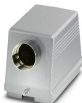
Tüllengehäuse, für Längsbügel, Höhe 96 mm, ohne Verschraubung, 1x Pg29, Kabelabgang seitlich
