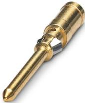
Crimpkontakt, Serie: HC-M-12, Stift, gedreht, Kontaktdurchmesser: 1,6 mm, Anschlussquerschnitt: 1,5 mm<sup>2</sup> ... 1,5 mm<sup>2</sup>, AWG 16...16, Material Kontakt: Cu-Legierung
